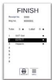
操作パネル 前面に10インチの大型タッチパネルを 装備し、採血管や患者様情報を表示します。 またタッチボタン操作により採血管の発行 指示、採血管の選択再発行操作が出来ます。
