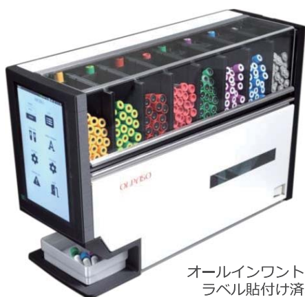
キャップカラーチェック カメラによる採血管の入れ間違いを チェック
