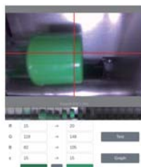
キャップカラーチェック カメラによる採血管の入れ間違いを チェック
